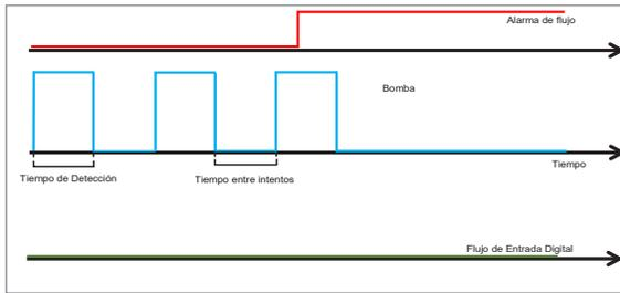
**Nota:** El sistema puede contar con un sensor de flujo de paleta con señal digital de "1" o "0"; o sensor ultrasónico con señal analógica mostrando el flujo en pantalla.
