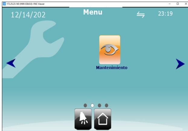
Al presionar este menú se podrá acceder a la visualización de entradas y de salidas de la máquina.
