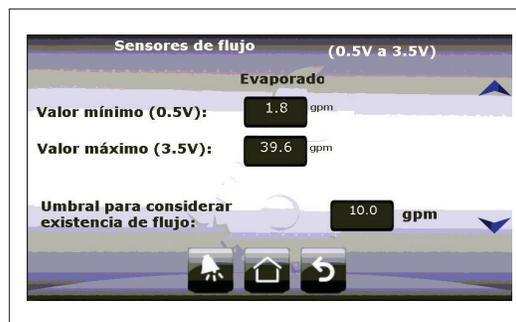
Este tipo de sensores no pueden medir más de 39.6 gal/min, en caso de que obtenga un valor mayor a este, se desplegará en la pantalla 295.6 aprox. Revise su sistema hidráulico para regular el flujo.
