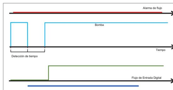
Si la detección de flujo falla después del periodo asignado para la detección de entradas digitales, es necesario apagar la bomba y reiniciarla para realizar un intento después de que el tiempo de espera entre lapsos haya pasado. Si después de un cierto número de intentos el flujo sigue sin ser detectado, la alarma de "falta de flujo constante" se activará y la unidad en cuestión quedará suspendida, tal como se ilustra en la Fig.7 de la siguiente página.
