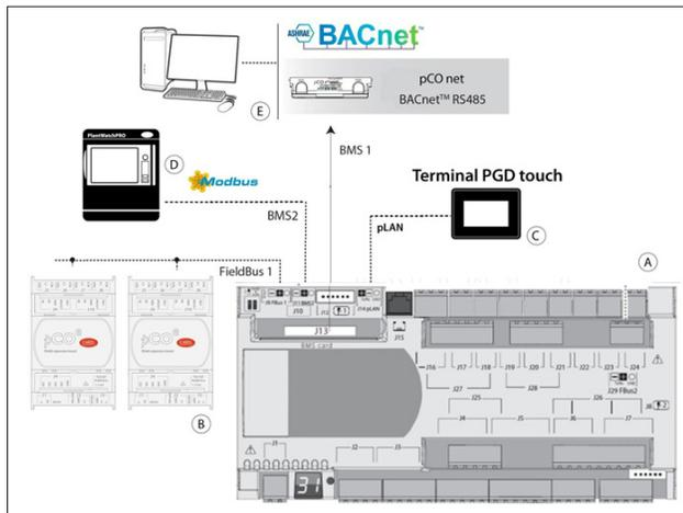
**Nota:** El puerto BMS1 requiere una tarjeta de comunicación (pCOnet a BACnet MS/TP o pCOWeb para BACnet IP). La programación del paquete lógico en el protocolo de alternancia también es necesaria. Igualmente puede ser conectado un FLG-Modbus para conectar un BACnet MS/TP.
