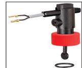
Por encima de este imán se encuentra un contacto de interruptor de láminas, aislado fuera de la cámara de flujo. Un segundo imán crea la fuerza necesaria para restablecer la paleta de nuevo a la posición de flujo cero.
