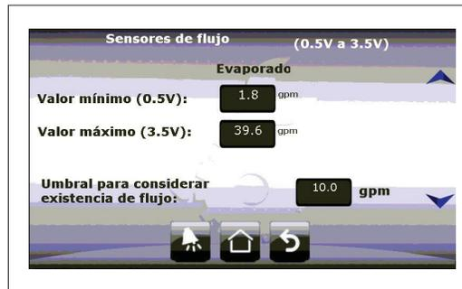
Además es posible calibrar el flujo mínimo permitido para encender el sistema, el sistema de la unidad necesita de 2.4 galones/ min por Tonelada.
