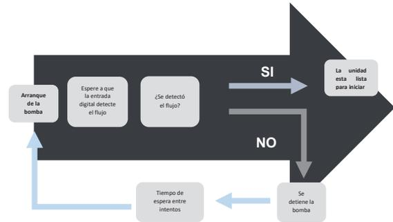
**Nota:** Si se sobrepasa el número de intentos de arranque de la bomba, se activará la alarma de flujo general, esto detendrá todas las operaciones en esa unidad hasta que la alarma sea reiniciada.
