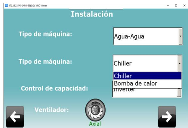
Después de haber seleccionado el tipo de trabajo de la maquina se procederá a seleccionar el control de capacidad del equipo.
